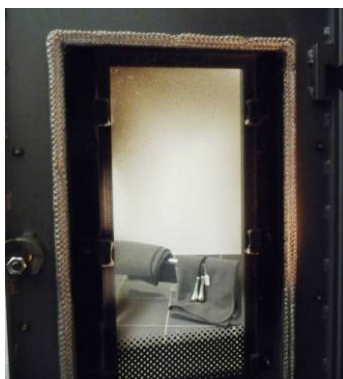
Fig. 10 : dépôt sur la vitre
