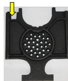
Fig. 16 : grille en fonte mal positionnée
