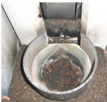
Fig. 11 : cendre dans la chambre de combustion
