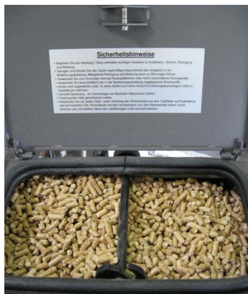
Fig. 7 : réservoir à granulés plein
