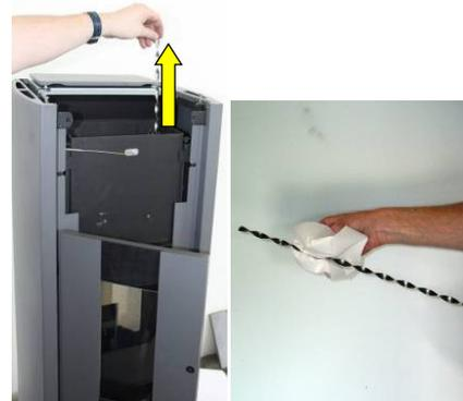
Fig. 27 : retrait et nettoyage turbulateur
