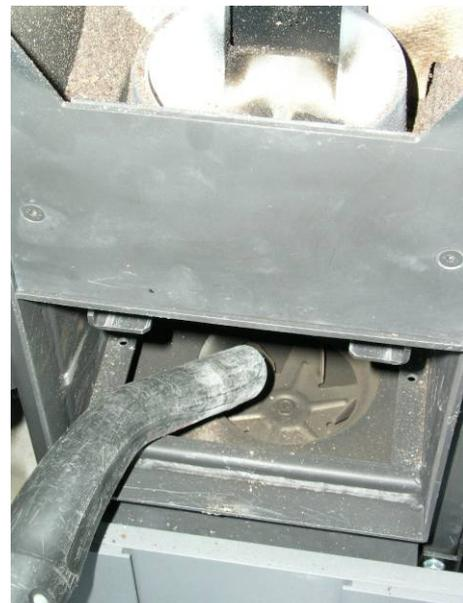
**Fig. 31 : nettoyage soufflerie**
