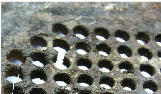
Fig. 20 : matériau de la grille fissuré
